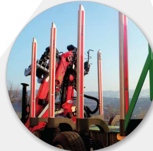
EXTE aluminium poles and extensions. Height 2,1 + 1,0 mt. Extension
