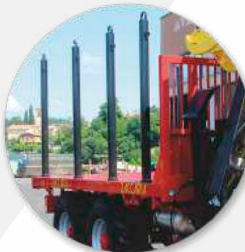
Stanti in acciaio spessore 10 mm da diam. 90 con vite di fissaggio alti 1,5 m con prolunga 80 cm.
