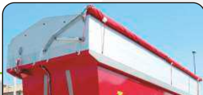
Copertura laterale con centina
