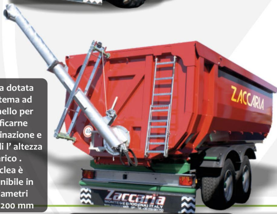
coclea dotata di sistema ad arganello per modificarne l'inclinazione e quindi l'altezza di scarico. La coclea è disponibile in nei diametri 150 e 200 mm
