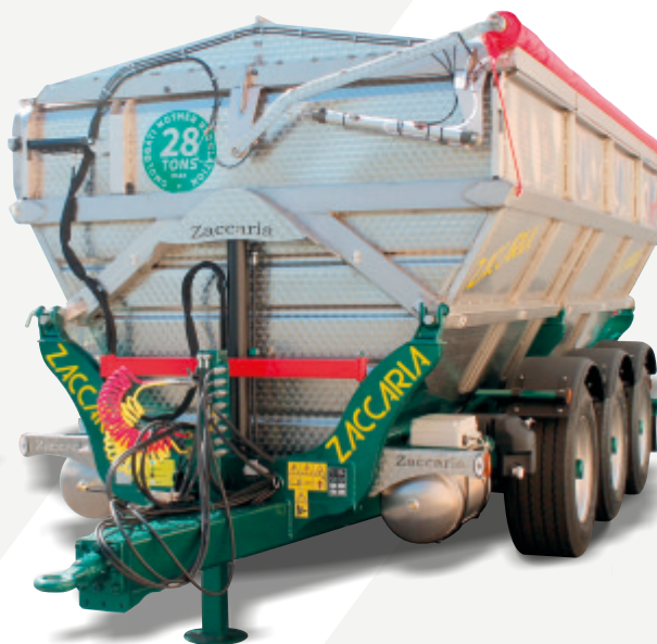
Copertura Laterale in PVC a funzionamento Pneumatico lato destro. Azionamento con radiocomando.
