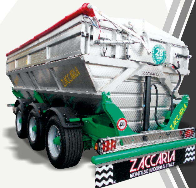
Copertura Laterale in PVC a funzionamento Pneumatico entrambi i lati, con rialzo telaio portatelo. Azionamento con radiocomando.
