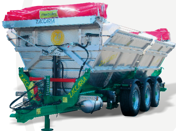
Copertura Manuale in PVC a scorrimento anteriore con manovella.
