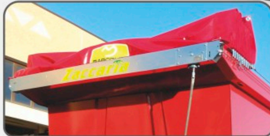
Copertura in PVC manuale
